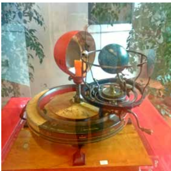
Tellurio, 1855. Strumento usato per spiegare i moti della Terra e della Luna
